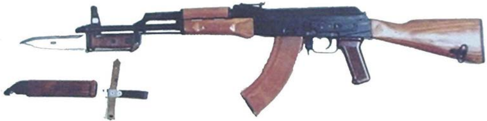
Şəkil 71. 7,62 mm kalibrli kompensatorlu AKM avtomatı
